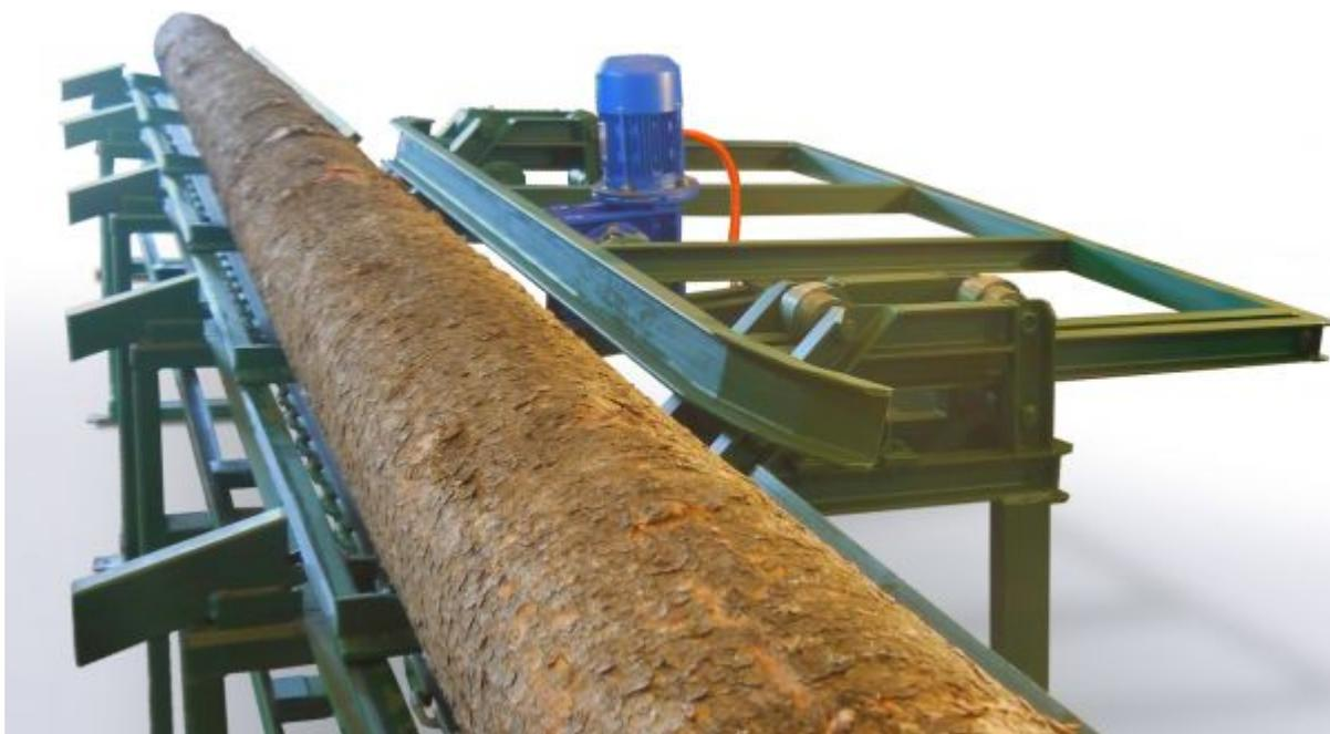
Механизм предназначен для сбрасывания бревен с продольных транспортеров на лесотранспортные механизмы. Бывают гидравлические и электромеханические, односторонние и двухсторонние. Сбрасыватель встраивают в магистраль за счет собственной станины. Это позволяет вместо промежуточной секции, в любом месте бревнотаски, установить сбрасыватель.
